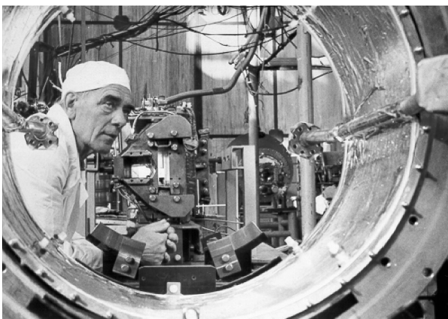
Лаборатория высоких энергий. Работы по созданию системы вывода и каналов выведенных пучков на нуклотроне
