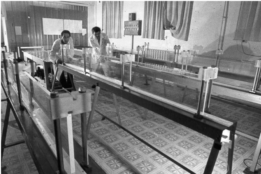
Лаборатория ядерных проблем. Работы по созданию крупных сцинтилляционных счетчиков для модернизации спектрометрического комплекса CDF на тэватроне FNAL (США)
