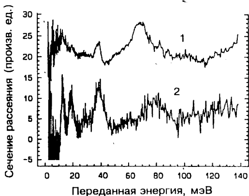
Рис.6. Спектры НРН воды, адсорбированной на стенках пор в пористом стекле Vycor glass [56]: 1) высушенный образец остаточной 10%-ной влажности, 2) разностный спектр «образец 100%-ной влажности — гексагональный лед»
