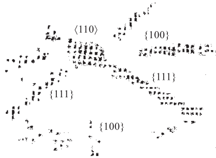
Рис. 27. Распределение [67] протонов с импульсом 15 ГэВ/с, упавших на монокристалл Ge толщиной 4,2 мм. Как и ранее, положения оси и плоскостей кристалла ясно различимы. Отмечается уменьшение выхода в окрестности угла падения \sim 1 мрад относительно оси и плоскостей. В картине 20000 событий
