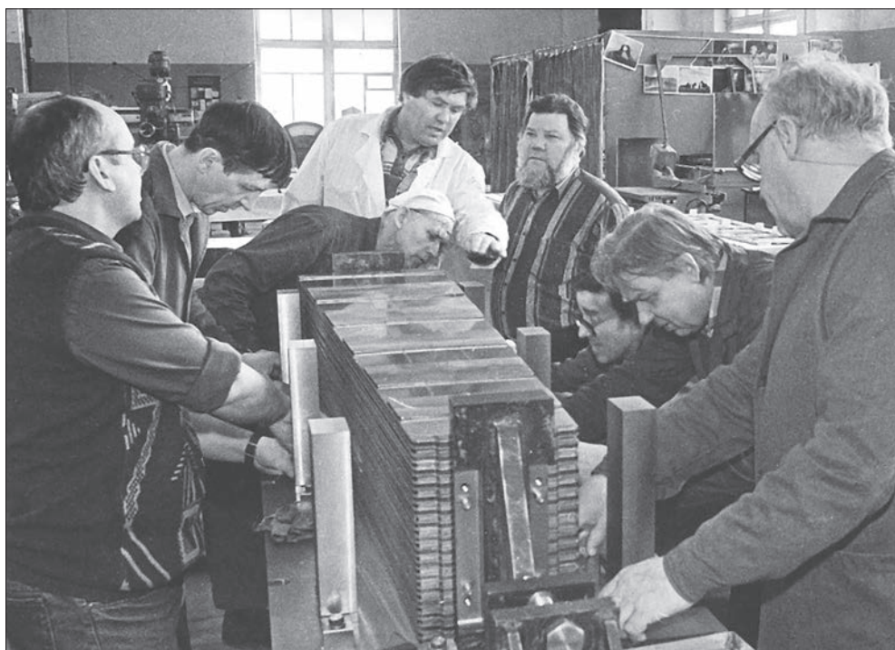
Сборка секции модуля в Дубне: отладка технологии
