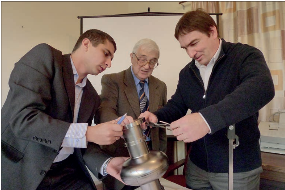
Ю. А. Будагов, Д. Л. Демин и Н. С. Азарян с образцами сверхпроводящих ниобиевых резонаторов
