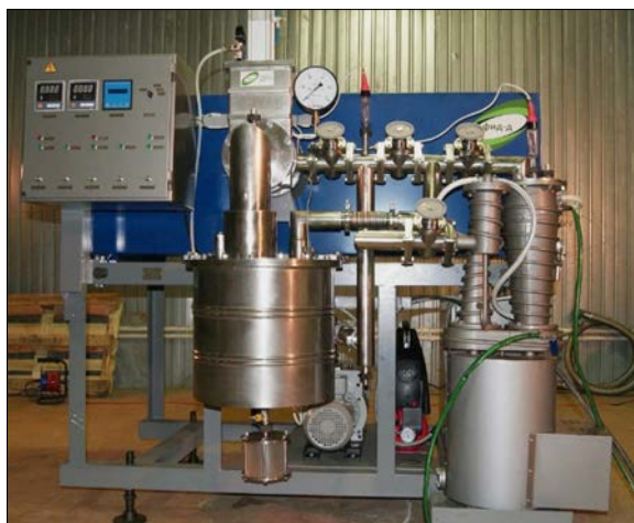
Рис. 11.3. Малогабаритная вакуумная термомеркуризационная установка УРЛ-2м [111]
