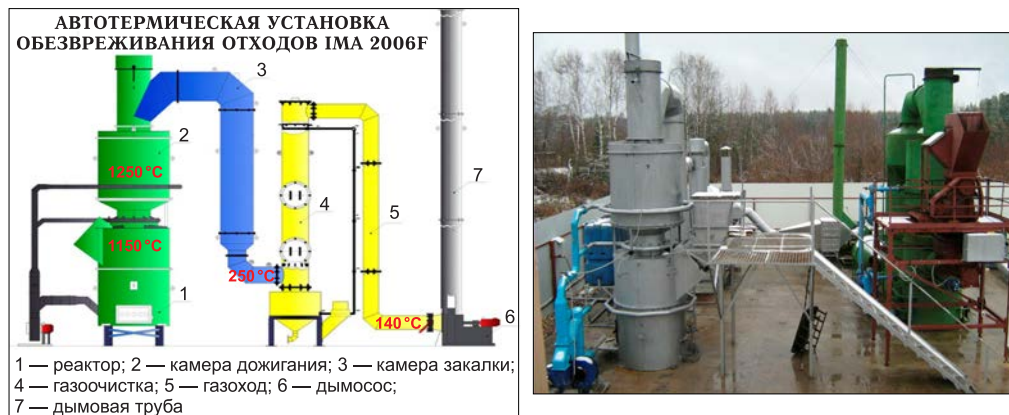
Рис. 11.7. Установка термического обезвреживания отходов «ИМА 2006F» [142, 143]
