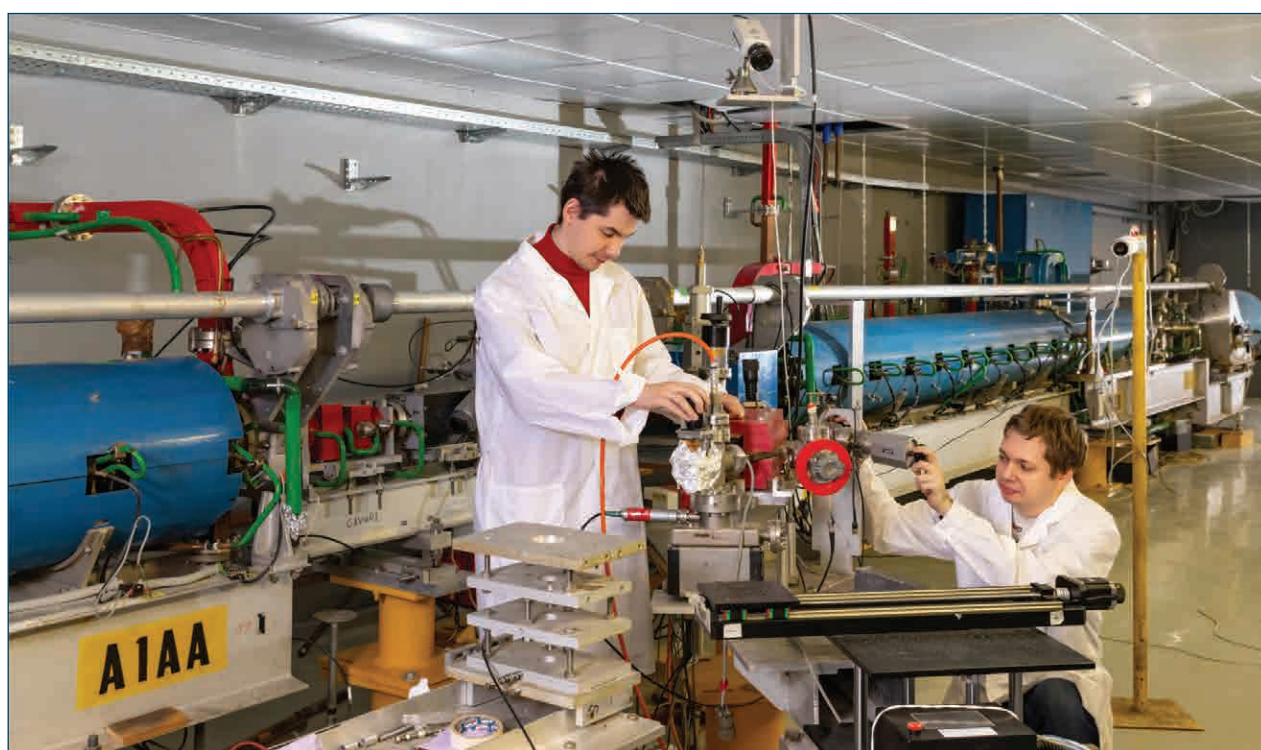
Рис. 35. Наладочные работы на ускорителе Линак-200
