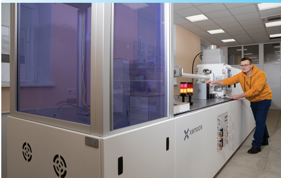
Рентгеновская установка XeuSS 3.0, которая позволяет проводить исследования наночастиц с помощью рентгеновского малоуглового рассеяния, а также изучать кристаллическую структуру методом рентгеновской дифракции
