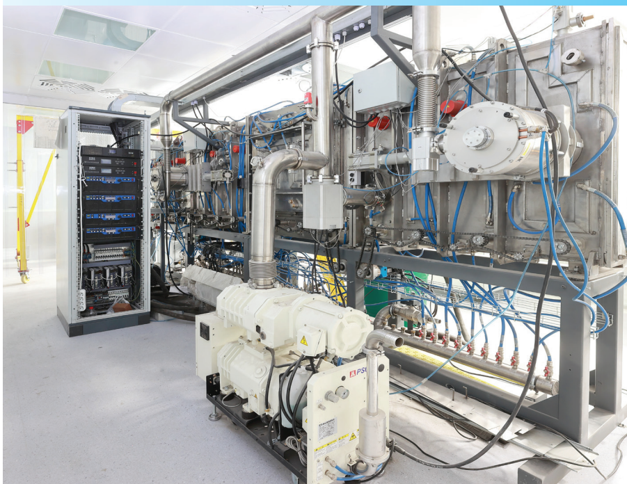
Установка по магнетронному напылению пленок карбида бора на подложки из различных материалов
