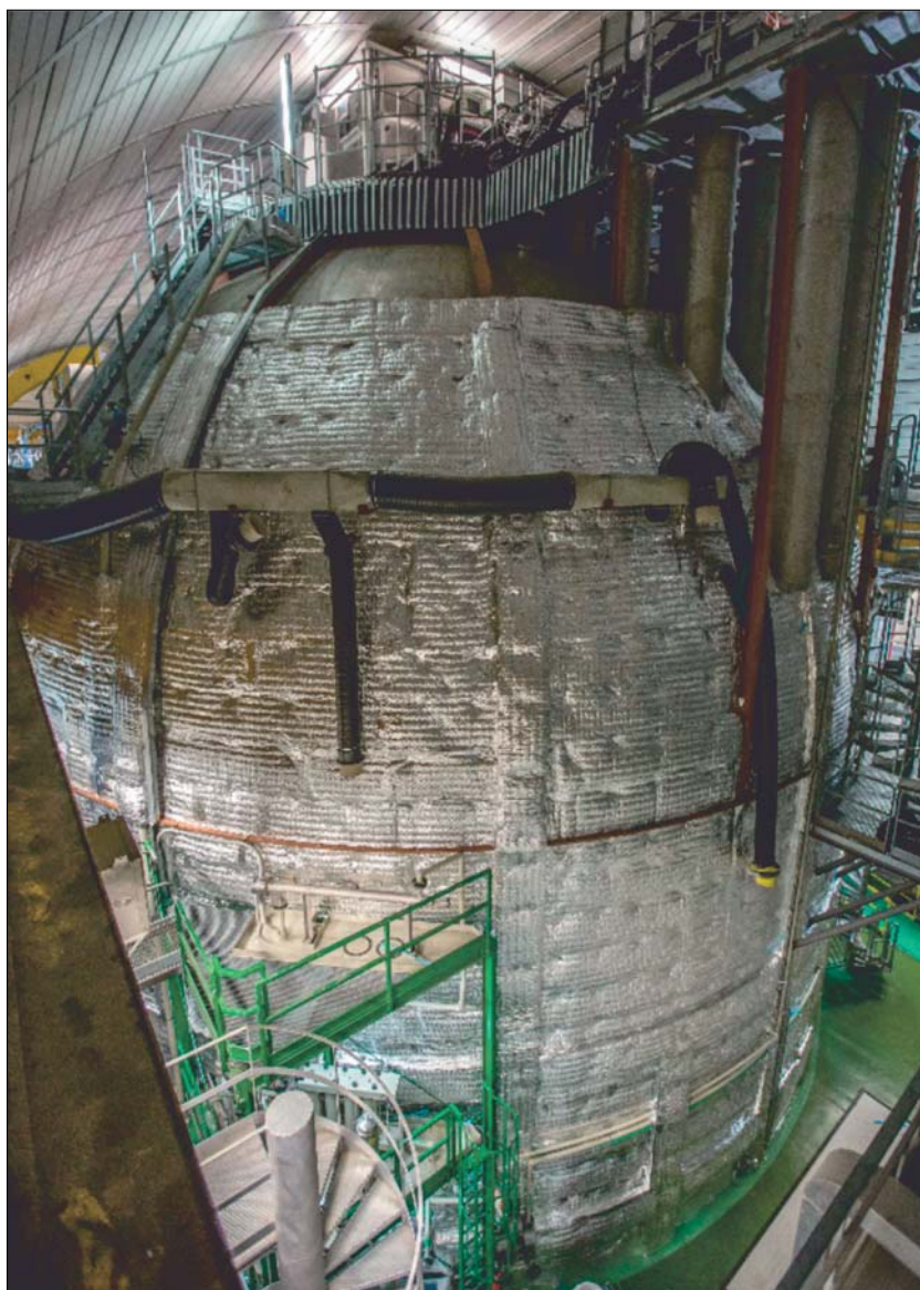
Рис. 2. Подготовка к измерению потоков нейтрино из CNO-цикла: термоизоляция детектора Borexino достигает уровня 14 м. В настоящее время термоизоляция установки завершена полностью
