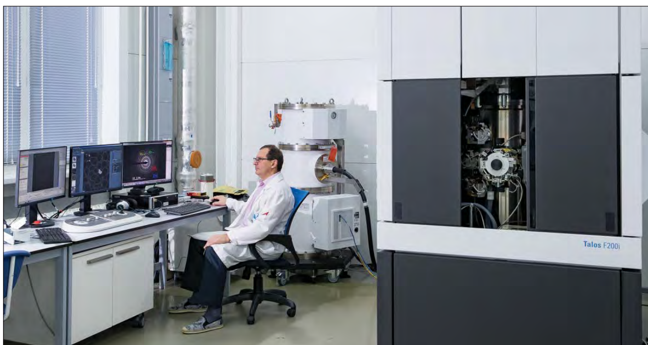
Лаборатория ядерных реакций им. Г. Н. Флерова. Введен в эксплуатацию просвечивающий электронный микроскоп Talos F200i для исследования радиационных эффектов в твердых телах и нанотехнологических приложений
