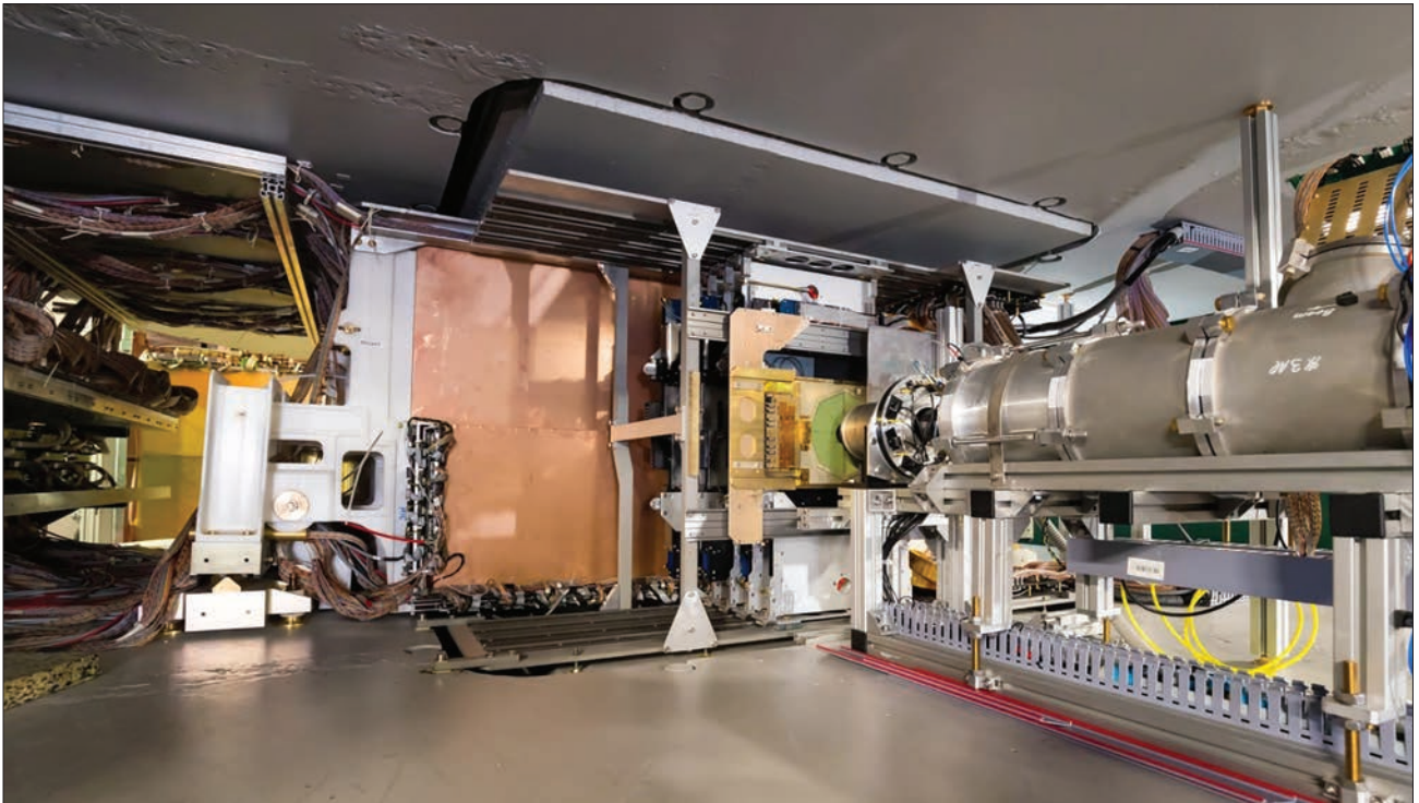
Триггерные детекторы мишенной зоны и центральная трековая система внутри спектрометрического магнита BM@N
