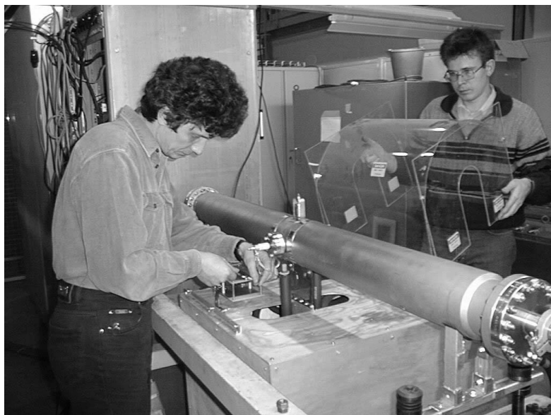
Лаборатория физики частиц. Стендовые испытания системы подавления поперечных колебаний пучка частиц LHC ЦЕРН
