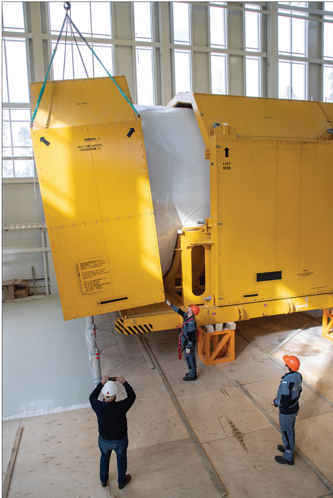
Лаборатория физики высоких энергий им. В. И. Векслера и А. М. Балдина, 23 марта. Снятие части транспортного кожуха с соленоидального магнита в павильоне эксперимента MPD
