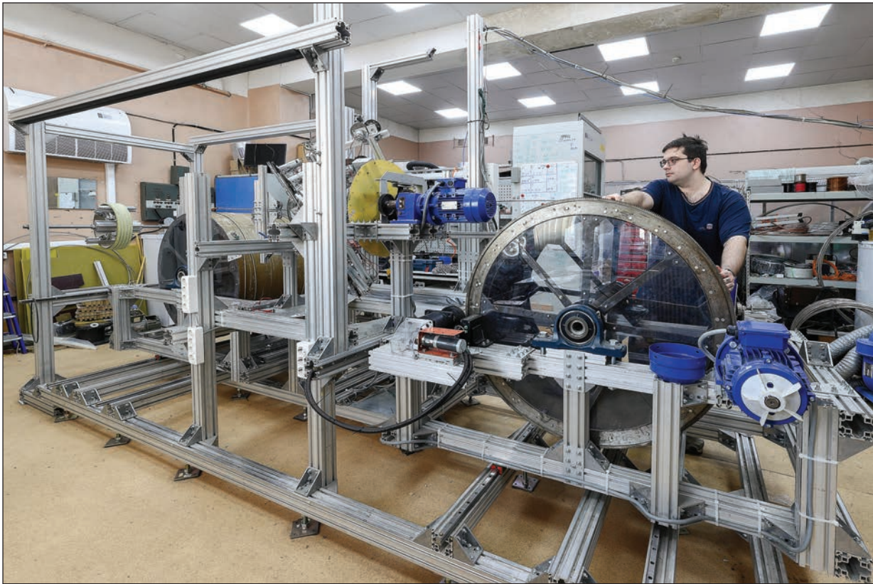
Лаборатория физики высоких энергий им. В. И. Векслера и А. М. Балдина. Установка для намотки ВТСП-магнитов
