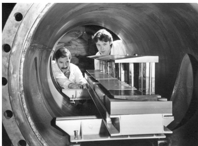
Лаборатория нейтронной физики им. И. М. Франка. Монтаж магнитного канала спектрометра СПН-2
