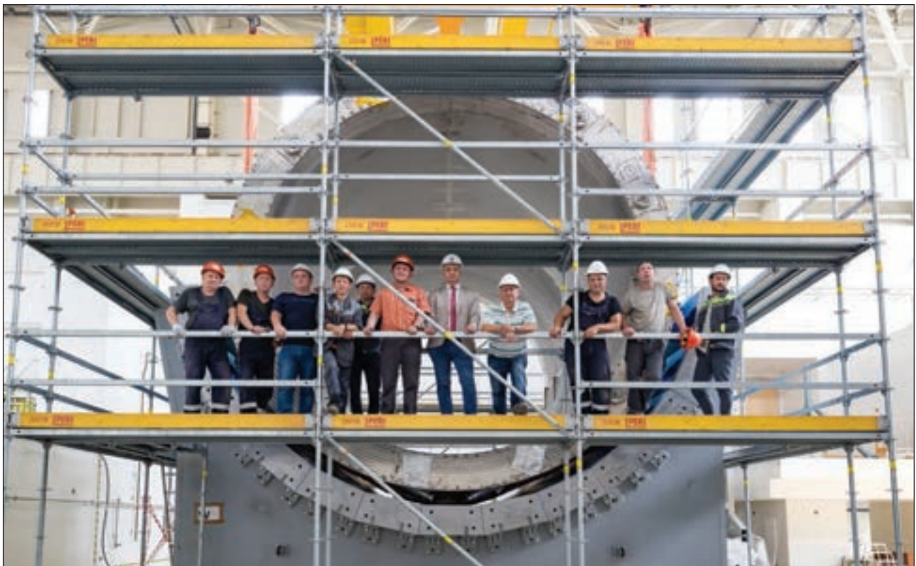
Лаборатория физики высоких энергий им. В. И. Векслера и А. М. Балдина, 29 июля. Сверхпроводящий соленоид детектора MPD ускорительного комплекса NICA установлен в штатном положении
