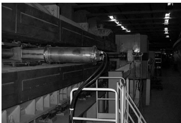
Рис. 11. Станция кристаллических дефлекторов, смонтированная на ускорителе У-70
