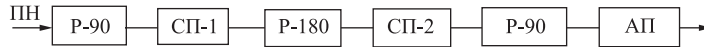
Рис. 51. Схема спин-эхо-спектрометра: P-90 — ротор поляризации на 90^\circ ; СП-1 и СП-2 — первый и второй спин-прецессоры; P-180 — ротор поляризации на 180^\circ ; АП — анализатор поляризации; ПН — пучок поляризованных нейтронов
