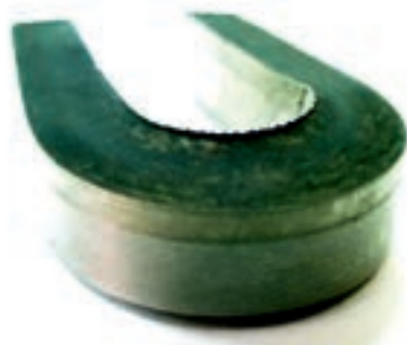
Рис. 10. Образец биметалла сталь-титан после испытания на загиб
