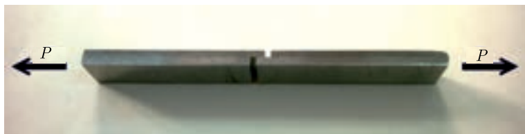
Рис. 12. Схема испытания образца на срез слоев
