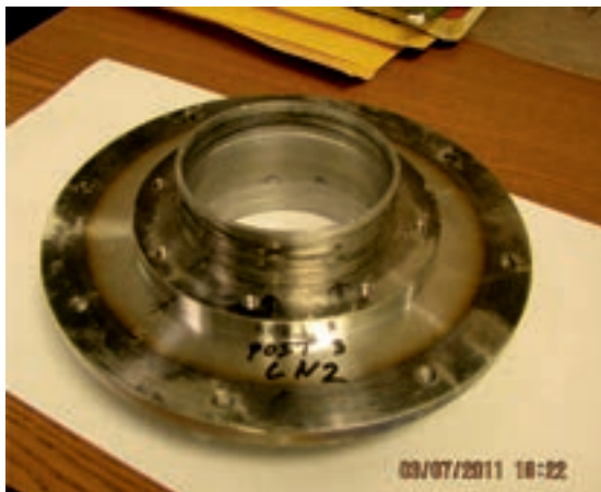
Рис. 5. Nb + SS-переходник с обнаруженными точками течи
