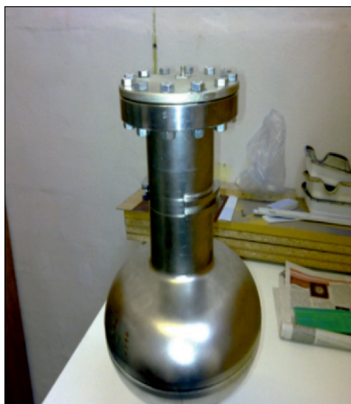
Рис. 43. Линия ввода СВЧ-мощности через верхний фланец криостата
