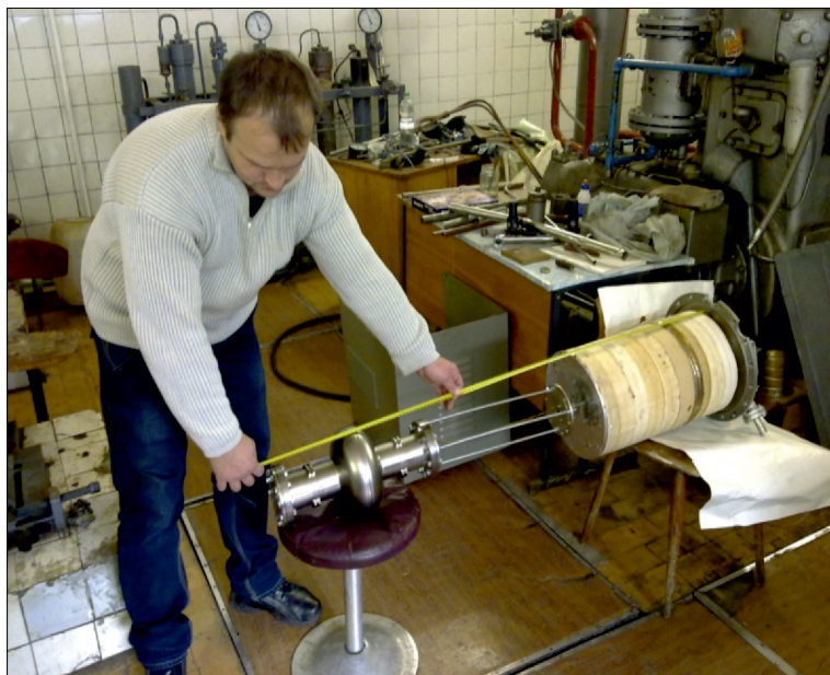
Рис. 46. Крепление резонатора к съемному фланцу криостата
