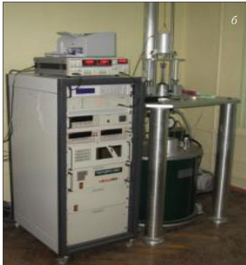
Рис. 36. Схема установки Liquid Helium Free High Field Measurement System для проведения электрофизических испытаний в интервале температур 4–300 К в поперечных магнитных полях до 14 Тл (а) и ее вид (б)
