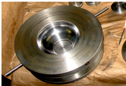
Рис. 20. Оснастка для гидроударной штамповки полувачек резонатора
