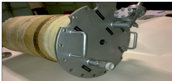
Рис. 44. Изолирующая пробка в верхней части криостата для минимизации теплопритока из теплой зоны
