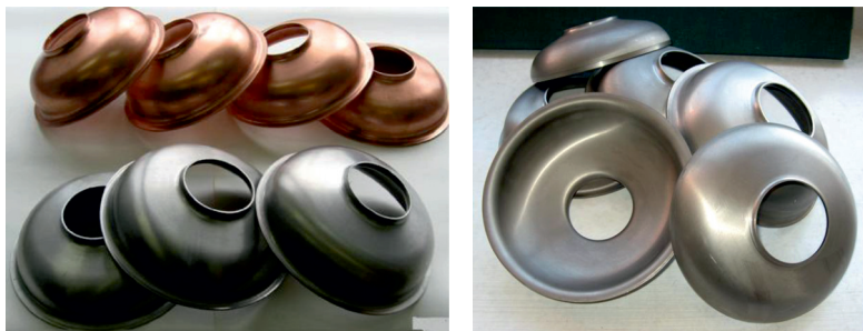
Рис. 21. Полулучейки из меди и алюминия (слева) и из ниобия (справа), изготовленные методом гидроударной штамповки на прессе СФТ-510
