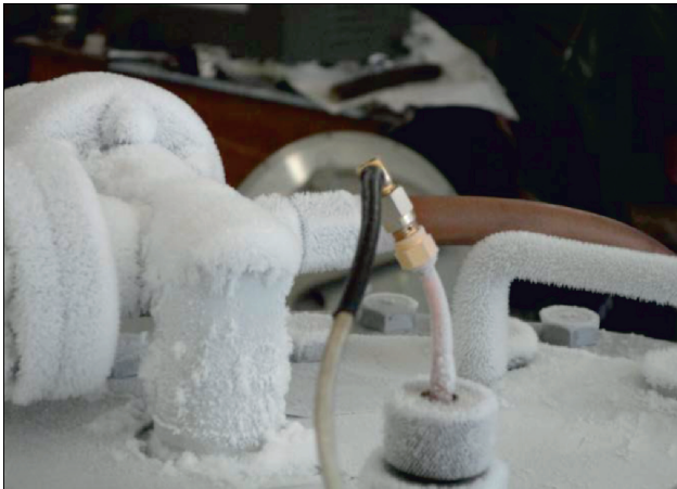
Рис. 53. Верхняя крышка криостата с выходным разъемом СВЧ-кабеля
