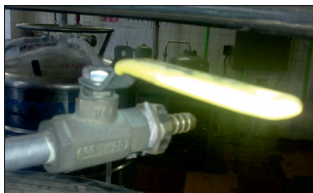
Рис. 42. Шаровой вентиль для регулировки давления паров гелия от 0 до 0,3 бар в криостате
