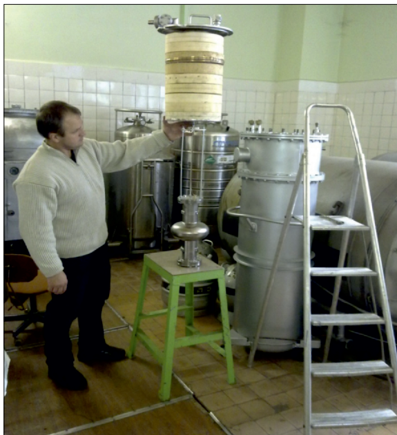
Рис. 47. Конструкция в сборе перед помещением в криостат
