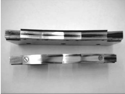
Рис. 20. Магнитный канал №1. Виден след от пучка
