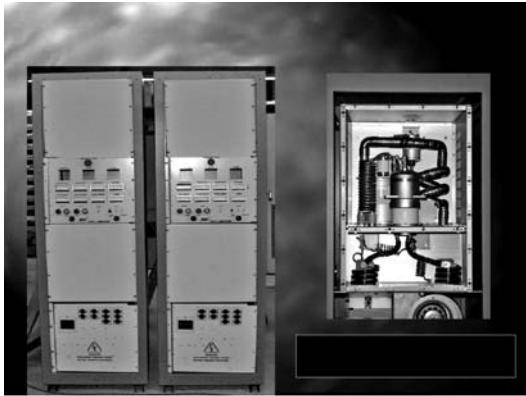
Рис. 29. Два ВЧ-генератора для независимого питания двух дуантов
