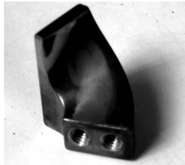
Рис. 8. Нижний электрод спирального инфлектора ИЦ-100
