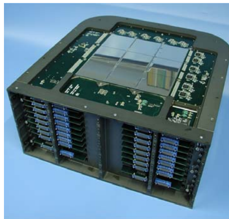
Рис. 2. Общий вид калориметра ПАМЕЛА
