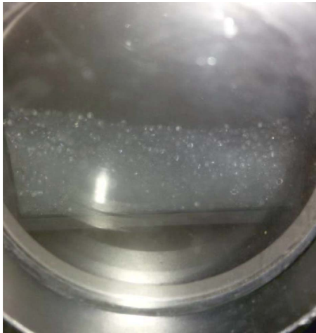
Рис. 8. Замороженные шарики, загруженные в камеру-имитатор испытательного стенда К3201
