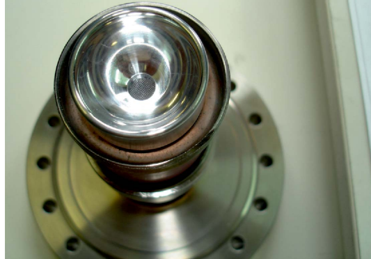
Рис. 1. Катодный узел пушки с «прозрачным» фотокатодом из перфорированного ( 200 \times 200 мкм) арсенида галлия
