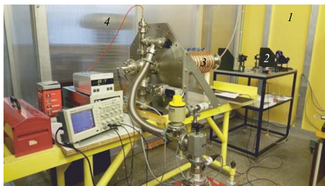
Рис. 2. Общий вид прототипа ДС-фотоинжектора: 1 — внешняя стенка лазерной комнаты; 2 — линия транспортировки лазерного луча; 3 — ускоряющая структура с фотокаатодом; 4 — высоковольтный источник питания
