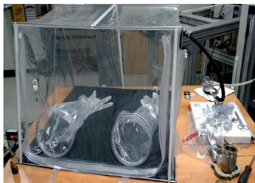
Рис. 1. ЭЦР-источник DECRIS-3 (а); аргонный бокс (б)
