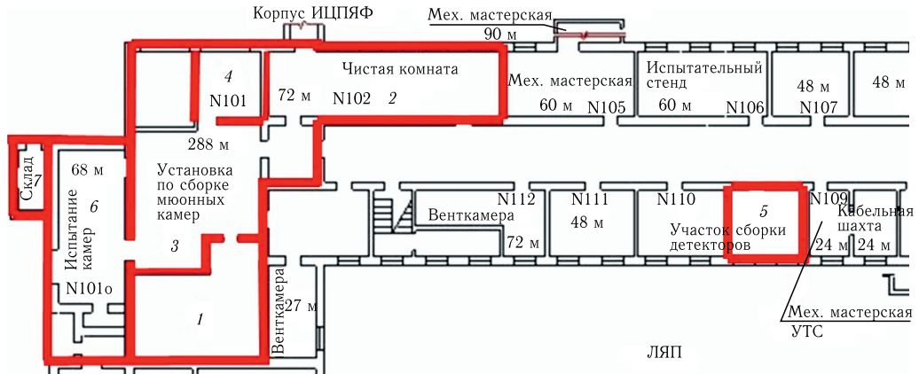
Рис. 5. Схема расположения производственных участков. Участок по производству Micromegas для NSW ATLAS: 1 – чистое производственное помещение (ЧПП) по производству считывающих панелей; 2 – ЧПП для сборки и тестирования модулей/квадруплетов; 3 – зал для стенда испытаний на космических лучах; 4 – комната тестирования на газовую течь панелей Micromegas; 5 – комната для мойки панелей. Участок полного производственного цикла по производству Micromegas-детекторов (6) и общая для обоих участков газовая комната (7)
