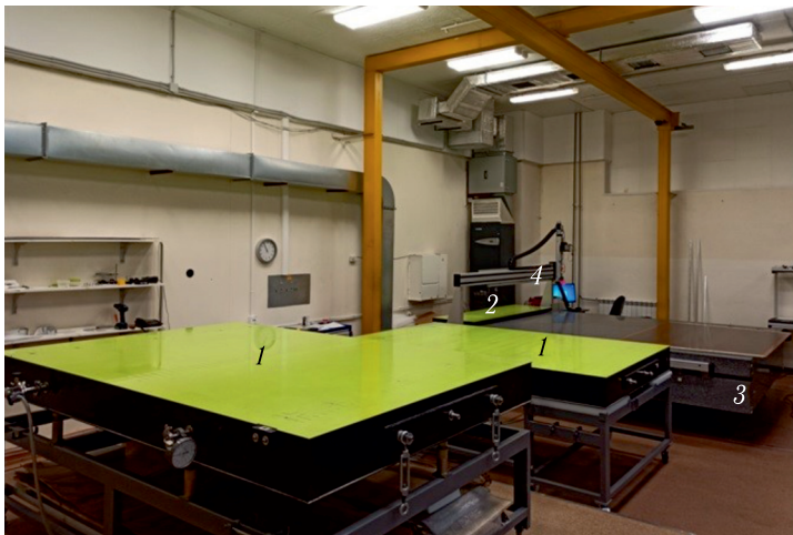
Рис. 6. ЧПП по производству и тестированию геометрических характеристик панелей. 1 – вакуумные столы; 2 – монтажный стол; 3 – гранитный стол; 4 – трехосевой линейный модуль с оптической системой бесконтактного измерения топологии
