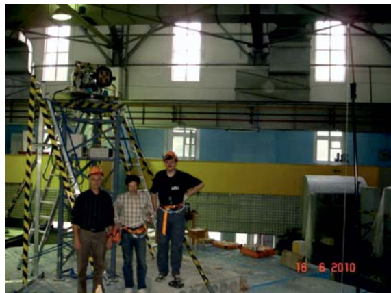
Рис. 6. Установка для проведения в ОИЯИ калибровок летных образцов ЛО-01 и ЛО-02 прибора LEND в экспериментальном зале реактора ИБР-2
