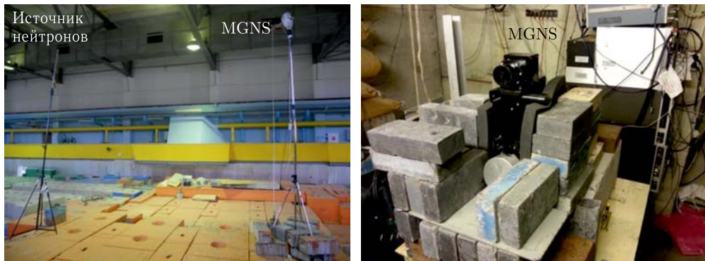
Рис. 10. Градуировка нейтронных детекторов MGNS в открытой геометрии (слева) и градуировка гамма-спектрометра MGNS на пучке тепловых нейтронов ИБР-2 (справа)
