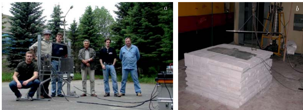
Рис. 15. а) Полевые испытания на территории площадки ЛЯП с макетом ДАН. б) Прототип модели марсианского грунта со слоем льда (полиэтилена) в глубине кирпичной сборки
