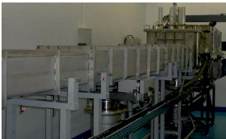
Рис. 6. Канал транспортировки пучка к установке для облучения полимерных материалов
