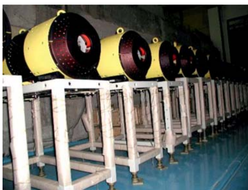
Рис. 8. Внешний вид квадрупольных линз
