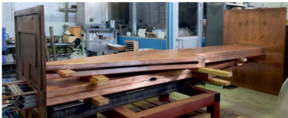
Рис. 7. Дуанты и дуантные штоки резонансной системы
