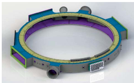
Рис. 4. Модель вакуумной камеры
