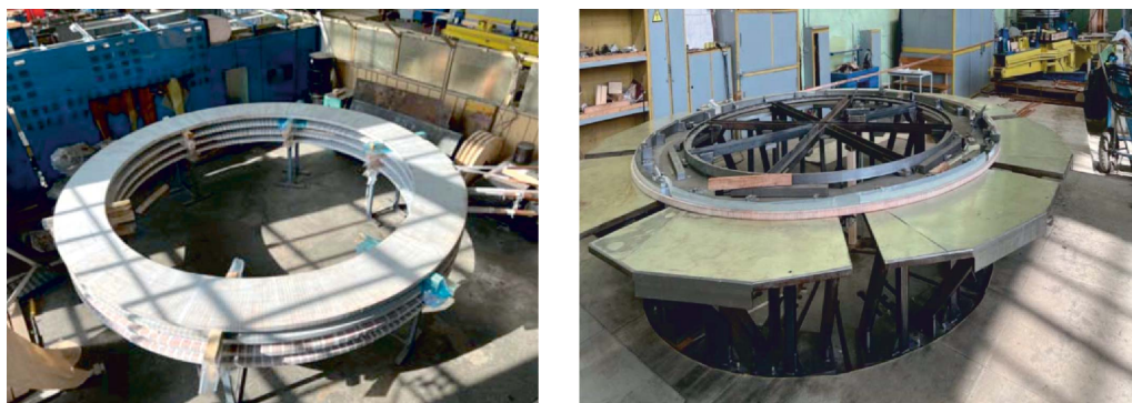
Рис. 3. Намотка секций основных катушек циклотрона
