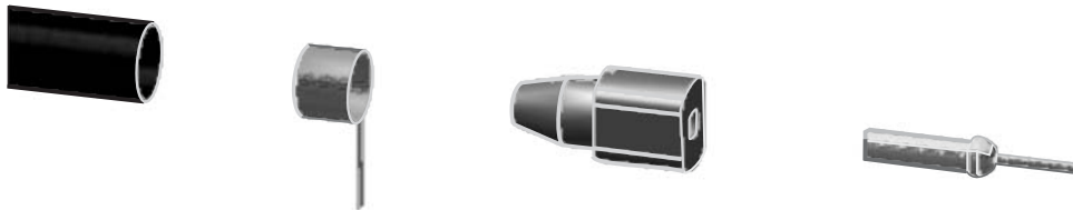
Рис. 7. Общий вид элементов фиксации анода в строу: металлическое кольцо «заземления» общего (независимо от количества сегментов) катода строу, литая пластиковая втулка, литая пластиковая втулка с медной трубкой
