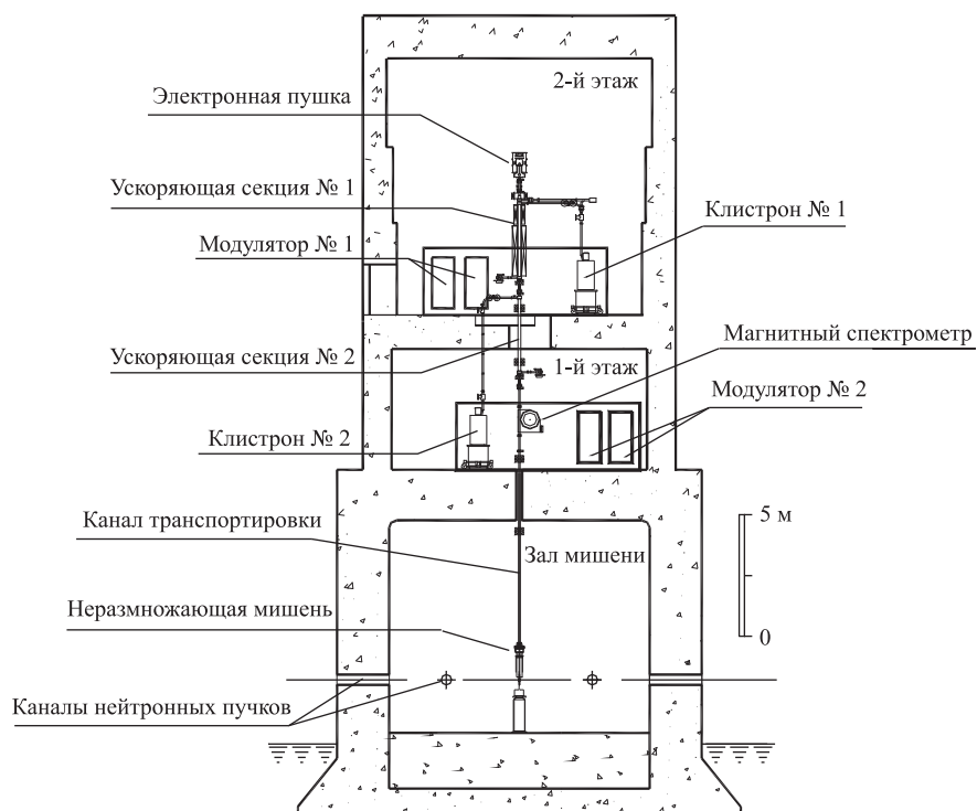
Рис. 1. Общий вид ускорителя в здании источника нейтронов ИРЕН ЛНФ ОИЯИ
