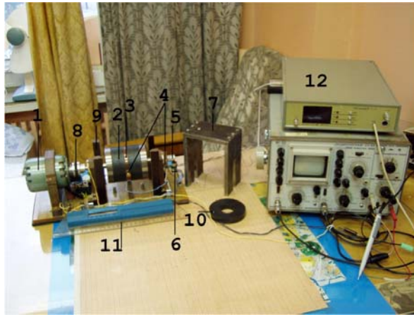
Рис. 3. Униполярный генератор со снятым ярмом и измерительными приборами
