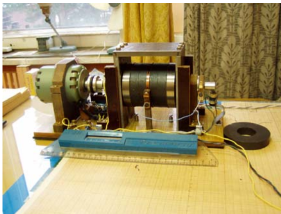
Рис. 2. Униполярный генератор с установленным ярмом
