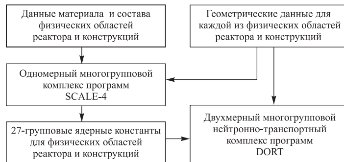
Рис. 1. Схема расчета изменения реактивности при термомеханических деформациях реакторных конструкций
