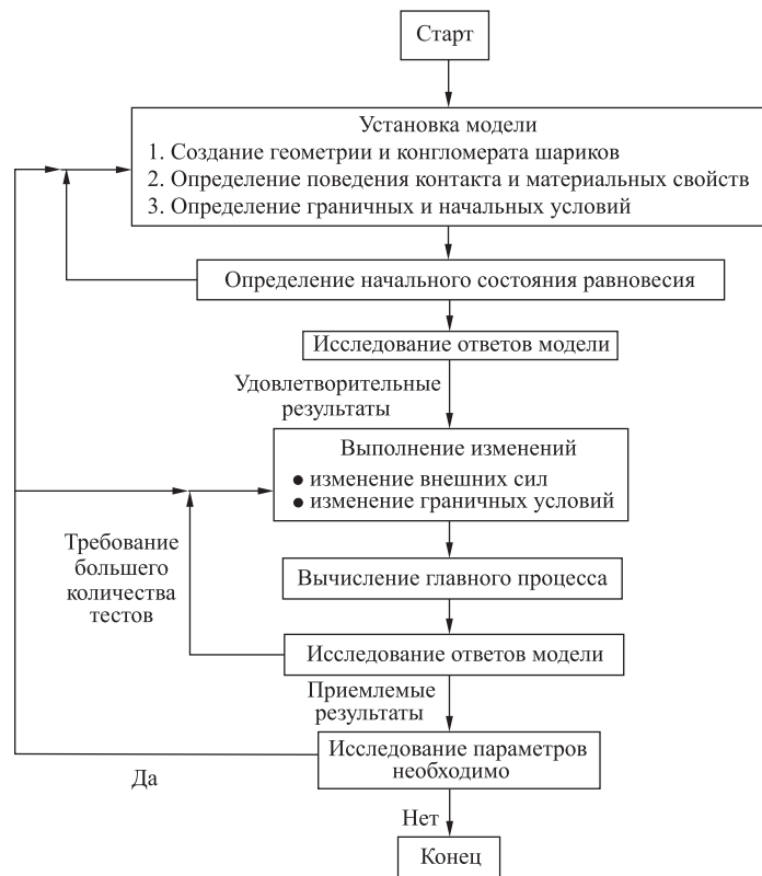
Рис. 3. Общая процедура моделирования в PFC-3D
