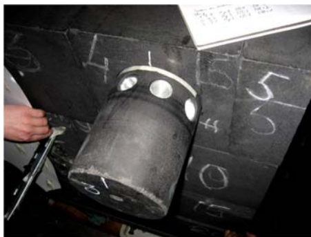
Рис. 3. Графитовая пробка с радиоактивными образцами ^{227}\text{Np} , ^{238}\text{Pu} и ^{239}\text{Pu} ; образец ^{129}\text{I} , расположенный левее, не виден
