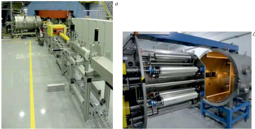
Рис. 6. Канал транспортировки пучка (а) и установка для облучения полимерной пленки (б)
