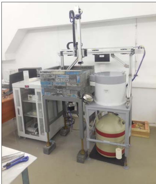
Рис. 6. Автоматическая система измерения спектров
