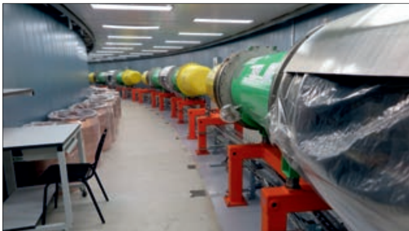
Магнитно-криостатная система бустера NICA в процессе сборки
