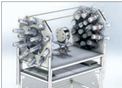
Позиционно-чувствительная двойная ионизационная камера для исследования МНД с 32 сцинтилляционными детекторами
