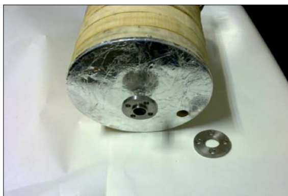
Рис. 3.17. Область подвеса резонатора к нижней части теплоизолирующей пробки
