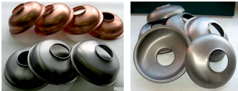
Рис. 2.9. Полуячейки из меди и алюминия (слева) и из ниобия (справа), изготовленные методом гидроударной штамповки на прессе СФТ-510
