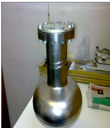
Рис. 3.15. Линия ввода СВЧ-мощности через верхний фланец криостата
