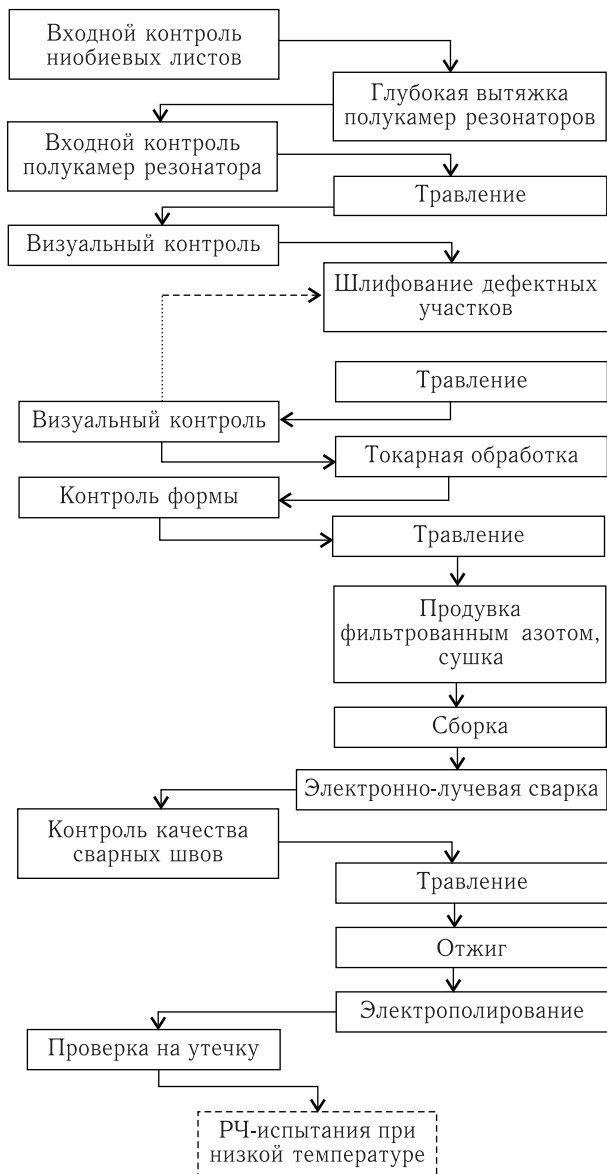
Рис. 2.13. Технологическая блок-схема процесса изготовления резонаторов
