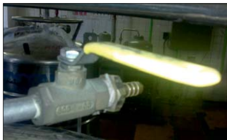
Рис. 3.14. Шаровой вентиль для регулирования давления паров гелия от 0 до 0,3 бар в криостате
