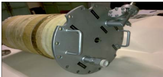
Рис. 3.16. Изолирующая пробка в верхней части криостата для минимизации теплопритока из теплой зоны
