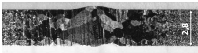
Рис. 3.1. Макрофотография сварного соединения особо чистого ниобия, шлиф протравлен ( \times 10 )
