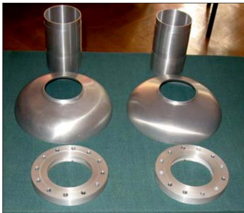
Рис. 2.11. Изготовленные детали одноячеечного резонатора
