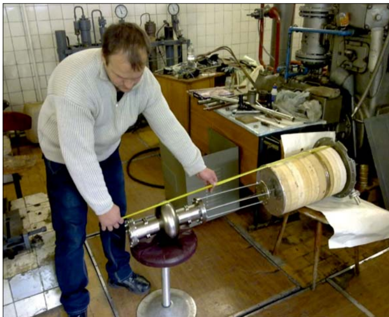
Рис. 3.18. Крепление резонатора к съемному фланцу криостата
