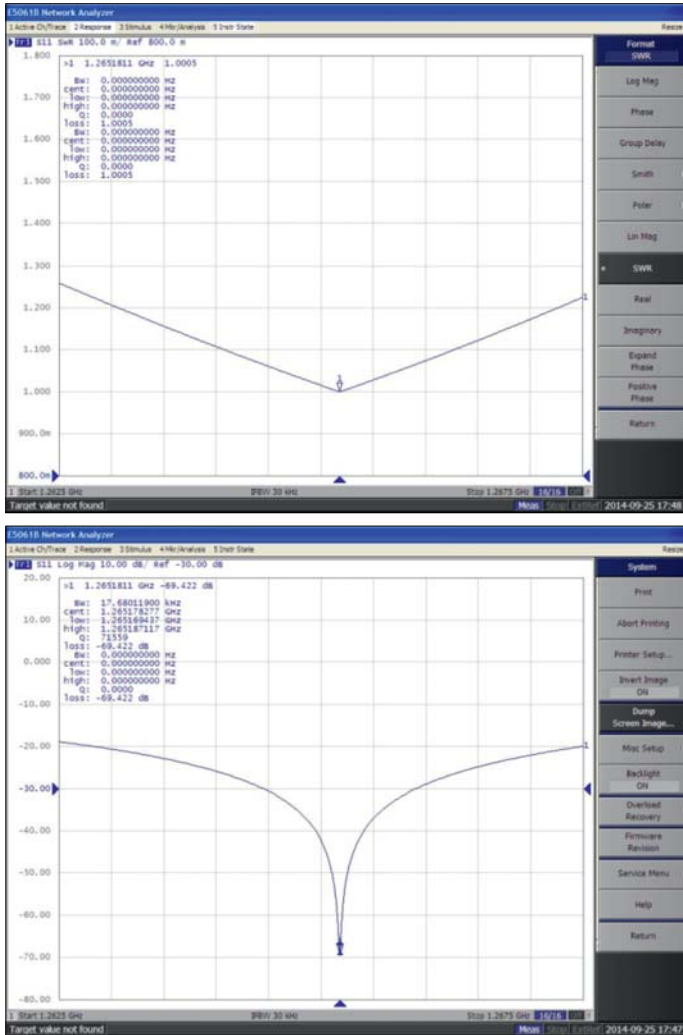
Рис. 4.17. Экспериментальные характеристики медного резонатора (резонансная частота, КСВ, добротность, относительный уровень потерь) при комнатной температуре
