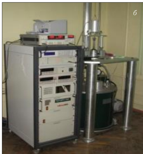
Рис. 3.8. Схема установки Liquid Helium Free High Field Measurement System для проведения электрофизических испытаний в интервале температур 4–300 К в поперечных магнитных полях до 14 Тл (а) и ее вид (б)
