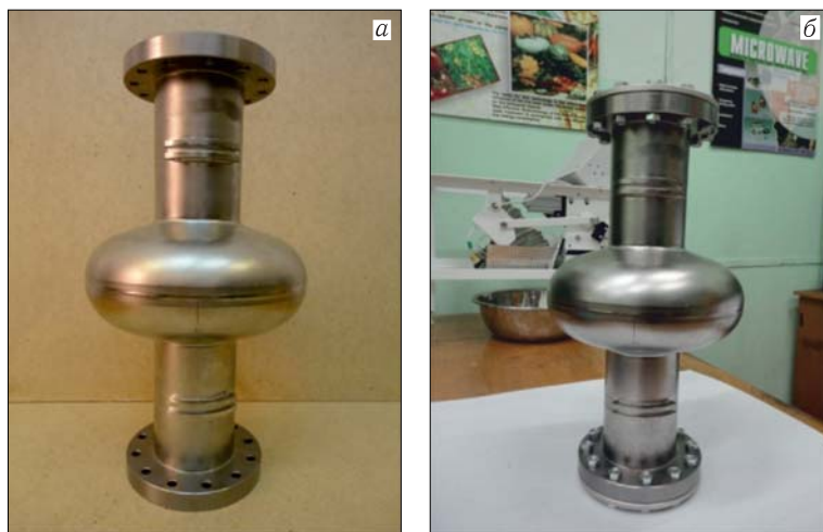
Рис. 4.2. Одноячеечный ниобиевый резонатор: а) без торцевых крышек; б) с торцевыми крышками
