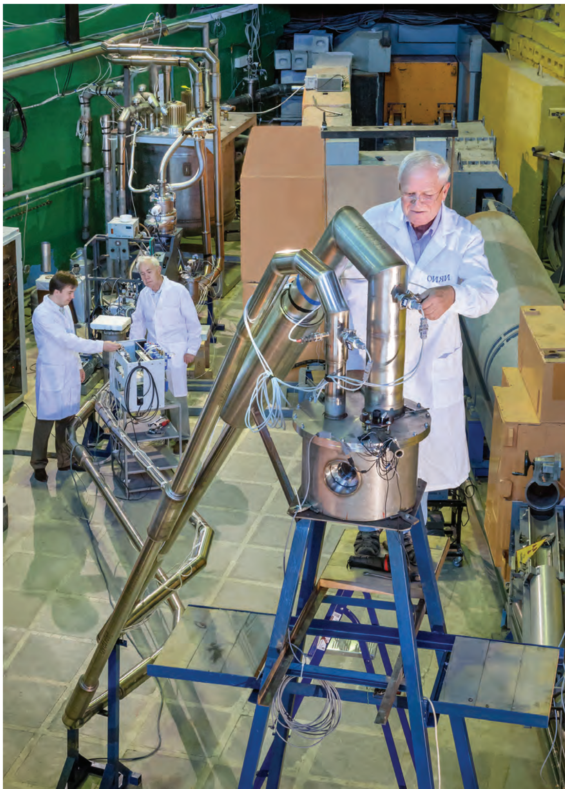
Лаборатория нейтронной физики им. И. М. Франка. Испытательный стенд криогенного замедлителя нейтронов ИБР-2
