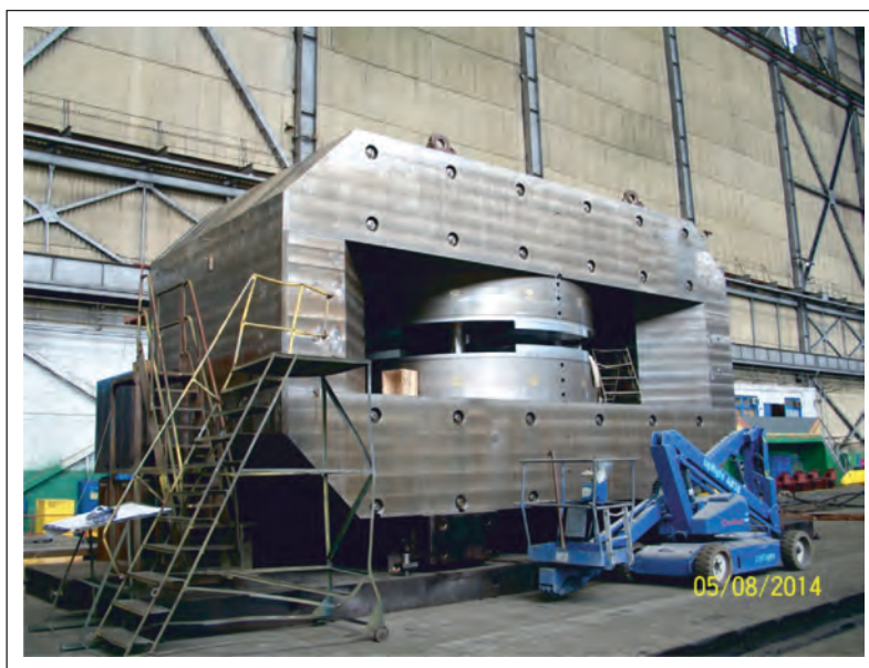
Рис. 1. Сборка сепаратора ACCULINNA-2 в экспериментальном зале циклотрона У-400М
