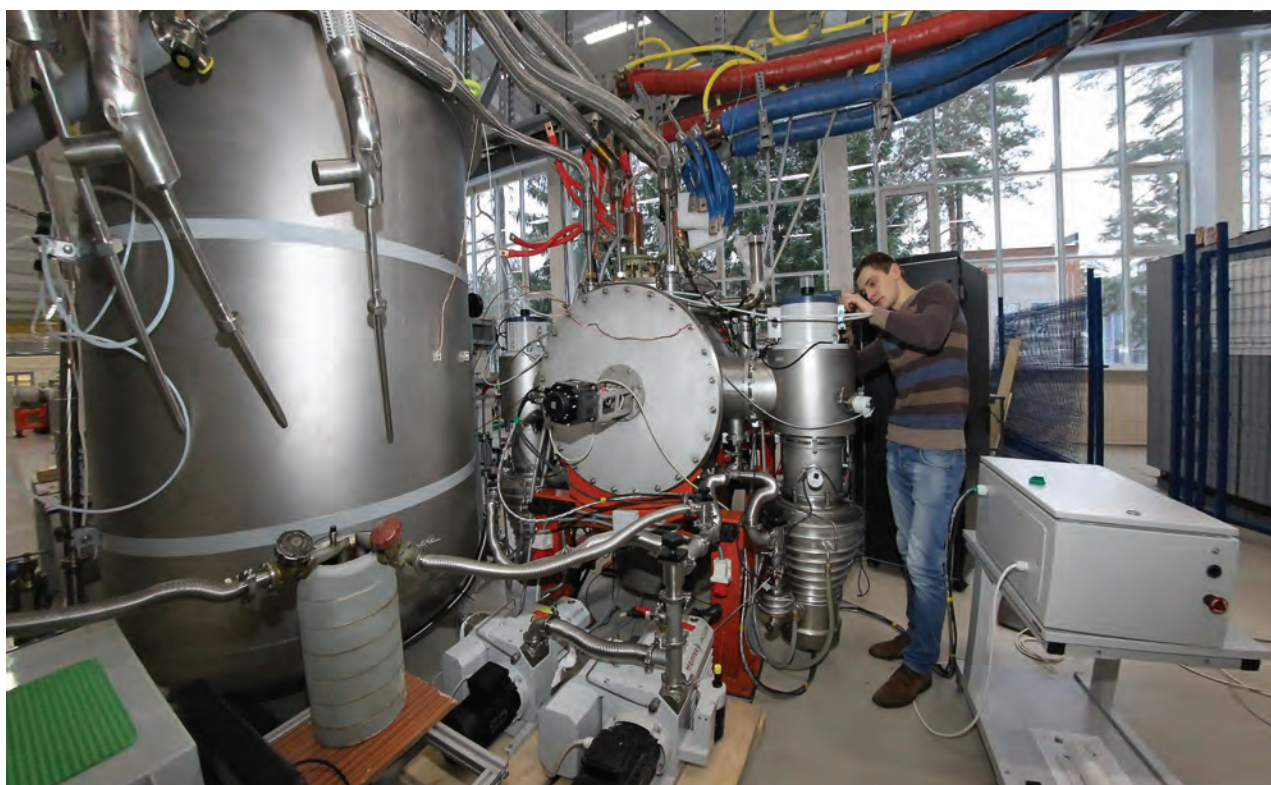
Лаборатория физики высоких энергий им. В. И. Векслера и А. М. Балдина. Испытания предсерийного дипольного магнита бустера: ведутся измерения магнитного поля
