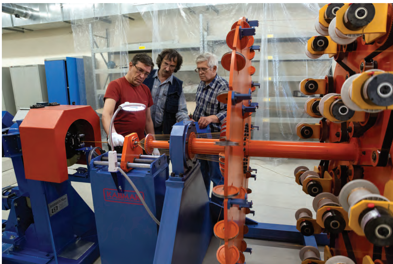
Лаборатория физики высоких энергий им. В. И. Векслера и А. М. Балдина, май. Линия производства трубчатого сверхпроводящего кабеля
